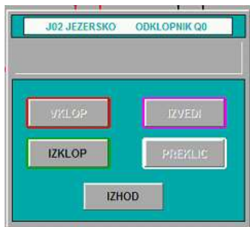
Slika 5: Princip organizacije okna za izvajanje stikalnih manipulacij
